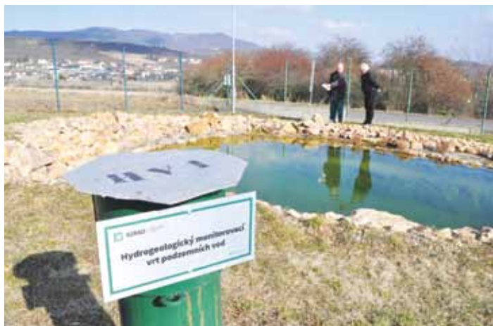
Jeden z monitorovacích vrtů se nachází přímo v areálu SÚRAO nad Litoměřicemi. Tam se od loňského roku nachází i nové jezírko na zachytávání důlní vody vytékající z úložiště. Foto: Radim Tuček
