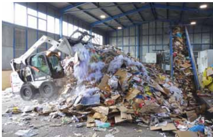
Na snímku z třídírny odpadu v Prosmykách vidíte svezení odpad z kontejnerů na papír. Ten je po dotřídění poslán po pásu do lisovny k dalšímu zpracování. Foto: Radim Tuček
