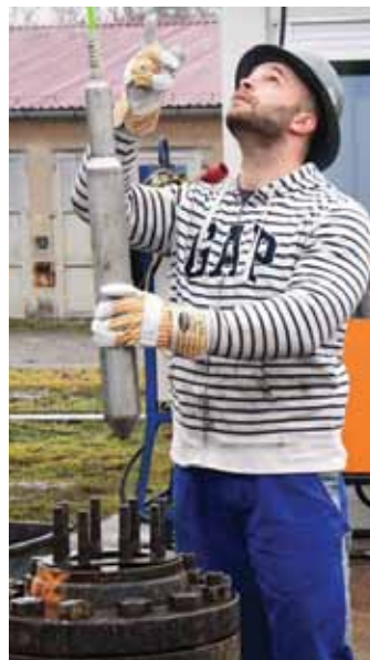
Seismometr byl spuštěn do hloubky 1 500 metrů.
